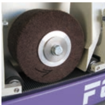
Glattes Finish nach dem Bandschleifvorgang mit einer optionalen Vliesbürste.
