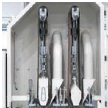
Alle Arbeitsstationen sind individuell zuschaltbar. So kann auch eine einseitige Bearbeitung erfolgen.
