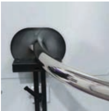
Gerade und gebogen Rohre: Fähig zum Betrieb mit Vorschub von geraden Rohren (automatisch) und manuell von gebogenen Rohren.
