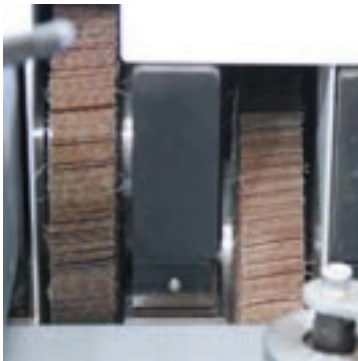
Optionale Lamellenschleifräder für das Kantenbrechen Ihrer Werkstücke.
