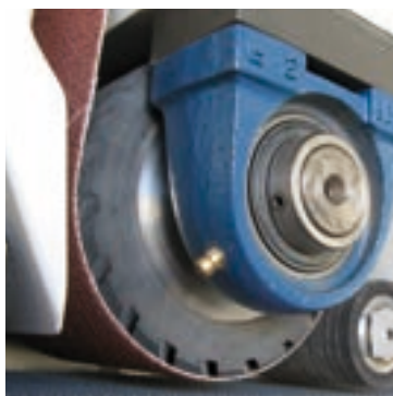
Schleifbandstation zum Oberflächenfinish und der Beseitigung von Unebenheiten für quadratische und rechteckige Rohre, Flachstangen und kleine Bleche.
