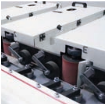
Vertikales Schleifband mit Oszillation für eine konstante Abnutzung der Schleifbänder.
