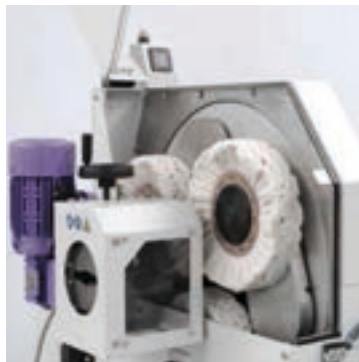
Planetenpolier-System, das aus drei Rädern besteht.
