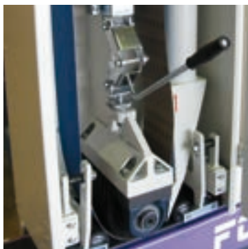
Die FC 120 ZK besitzt standardmäßig eine Schleifbandstation mit Schnellwechsellvorrichtung.
