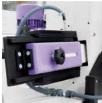
Automatische Zufuhr von Polierseife durch Zeitschaltuhr oder durch Betätigung eines Drucktasters.
