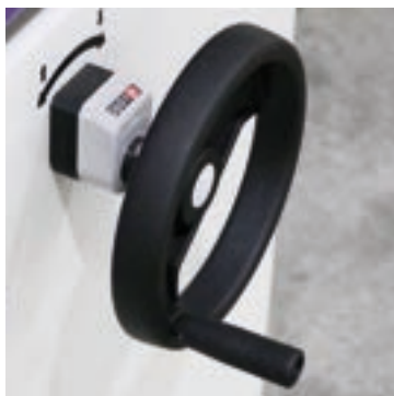
Einfache Materialstärken Handhabung mit Anzeige in 0,1 mm Schritten.
