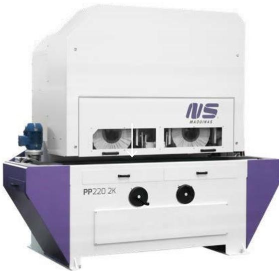
Zwei unabhängige Polierstationen mit der Möglichkeit, Druck und Geschwindigkeit jeder Einheit individuell anzupassen.
