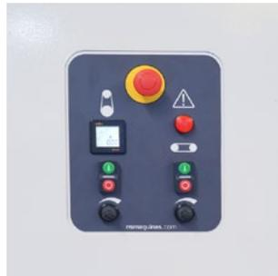
Intuitives Bedienfeld mit einem digitalen Amperemeter zur Überprüfung des Kontaktwalzendrucks.
