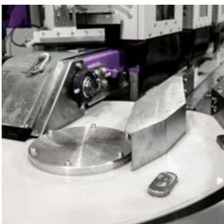
Automatische Rückführung von Kleinteilen für den Einmannbetrieb.
