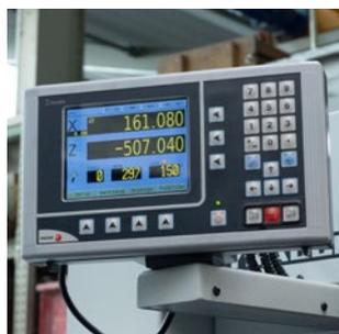
Optionale Konstante-Schnittgeschwindigkeit über Digitalanzeige FAGOR 40i TS.
