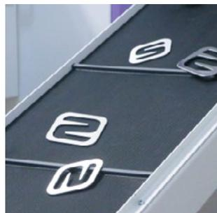
Das optionale Teilerückführsystem verbessert die Produktivität bei kleinen Werkstücken oder der beidseitigen Bearbeitung.
