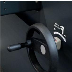
Die Materialstärke wird über ein Handrad und eine Anzeige mit einer Genauigkeit von 0,1 mm eingestellt.
