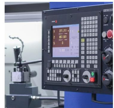
Unsere Zyklengesteuerten Drehmaschinen bilden die Basis zwischen konventionellen und CNC Drehmaschinen. Die einfache Handhabung und das horizontale Maschinenbett bieten bestens gerüstete Maschinen für die Instandhaltung und Ausbildung.
