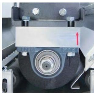
Bürsteneinheit mit Oszillationsfunktion (150 Hübe/min).
