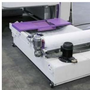
Der automatische Filter gewährleistet die kontinuierliche Erneuerung und Überwachung der Filterpapiereinheit.
