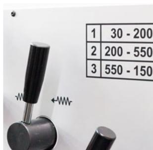
Drei Drehzahlbereiche verstellbar stufenlos über einen Potentiometer am Schlitten.
