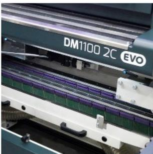
Doppelseitiges Kantenverrunden von Laser-, Wasserstrahl- und Stanz-Teile.
