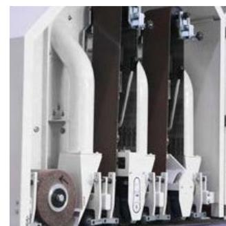
Die Anpassung an unterschiedliche Dicken erfolgt durch die Bewegung der Schleifstationen. Sie sorgt dafür, dass das Förderband immer auf der gleichen Höhe bleibt. Dies erleichtert die Bearbeitung langer Röhre, Profile und Stangen, ohne dass Anpassungen erforderlich sind.
