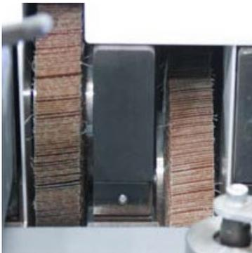
Optionale Lamellenschleifräder für das Kantenbrechen Ihrer Werkstücke.
