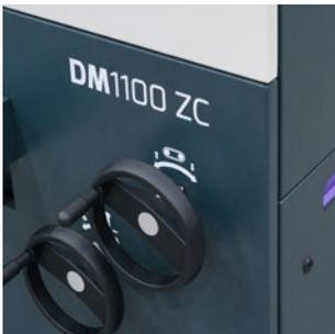
Die Materialstärke und der Schleifdruck der Bänder wird über ein Handrad eingestellt.
