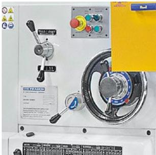
Drehzahlverstellung über Hochleistungs-Getriebe mit gehärteten Zahnrädern.
