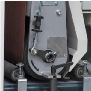
Die Schleifbandstation verfügt über eine Kontaktwalze mit großem Durchmesser (Dm. 180 mm und 55 SH).
