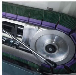
Zwei Quergurtbänder arbeiten in entgegengesetzter Richtung. Sie verrunden jede Stelle des Werkstücks.
