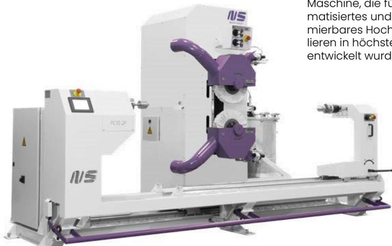
Maschine, die für ein automatisiertes und programmierbares Hochglanzpolieren in höchster Qualität entwickelt wurde.
