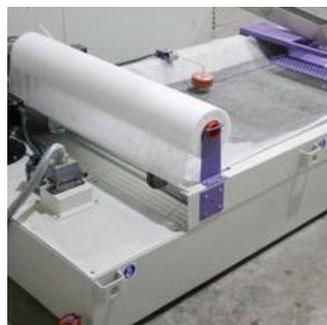
Das automatische Wasserfiltersystem sorgt für eine autonome Nachführung und Überwachung der Sauberkeit des Filterpapiers.
