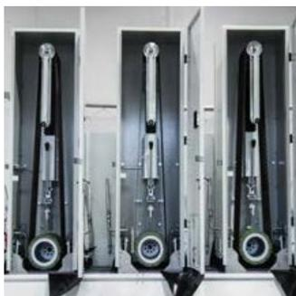
Voneinander unabhängige Schleifstationen, so dass eine genaue Einstellung jeder einzelnen Station möglich ist.
